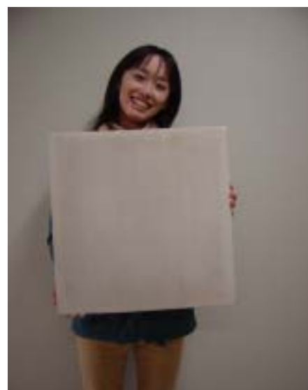
水熱反応を利用し、使用済みガラスピンから作成した軽量発泡板
