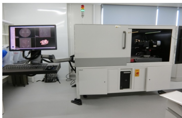
海底鉱物資源微細構造3DX線観察システム 海洋コア総合研究センター 物部キャンパス
